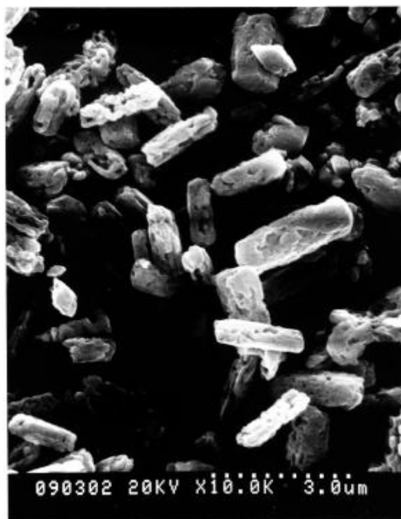
Abbildung 3: Links: REM-Aufnahme des ungemahlene Ga 2 O 3 -Pulvers der Fa. Alfa. Rechts: REM-Aufnahme des 4h in der Planetenmühle gemahlene Ga 2 O 3 -Pulvers der Fa. Alfa
